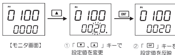
図3-17 SRS11A型（シマデン製）の設定方法
