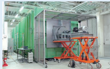
送風機性能試験装置 (AMCA)
