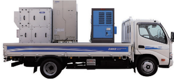
2tロング車で仮設空調機を輸送
